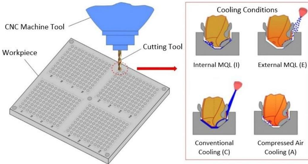
Figure 1. Schematic representation of the experimental setup (Deney düzeneğinin şematik görünümü)
