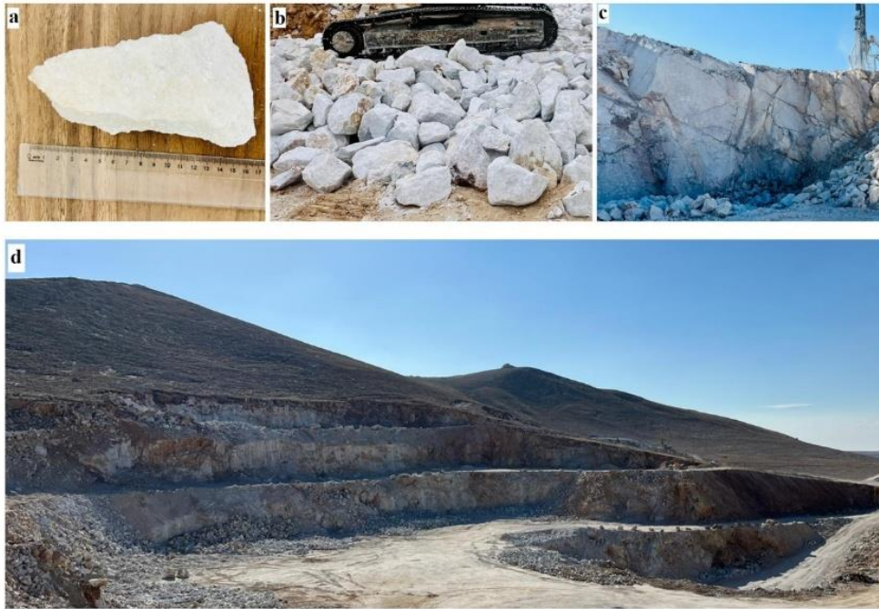
Şekil 2. Çalışma alanındaki kalsitlerin (a) el örneği, (b) patlatma sonrası kırılmış boyutu ve (c) ocak kademelerinden görünümü, (d) açık işletme yöntemiyle madencilik faaliyetinde bulunulan bir ocak alanı (Konum: Oymağaç köyü/Ortaköy)
